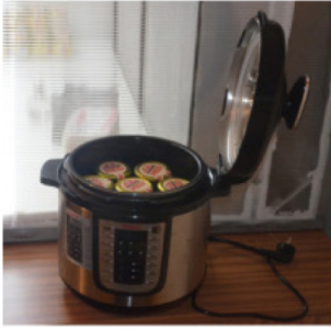
Obr. 3 Můj autokláv z papiňáku
